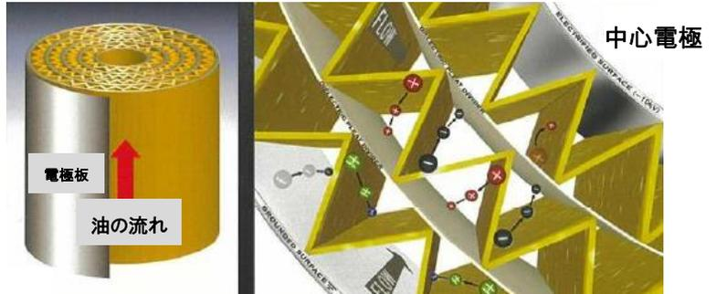
トランスにより10,000V以上に昇圧された電圧を電極板に強い静電気を発生させその力を利用してコンタミを集塵する方式です。
