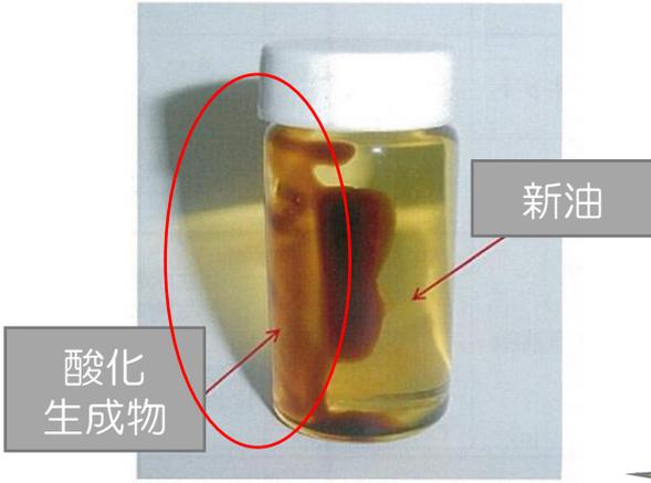
固形滞在物や酸化した油は新油に溶けません。油交換をしても機械内部に残り続けてしまいます。
